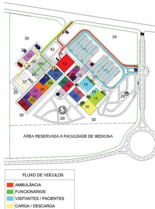
Fig.4: Exemplo de zoneamento com análise de fluxo
