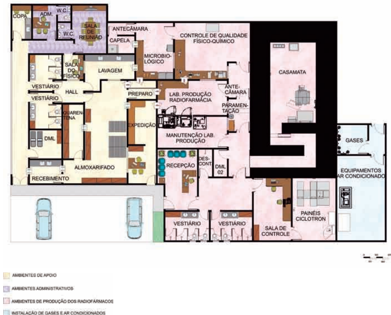
Fig.1 – Planta baixa de um Centro de Produção de Radiofármacos, com setorização
