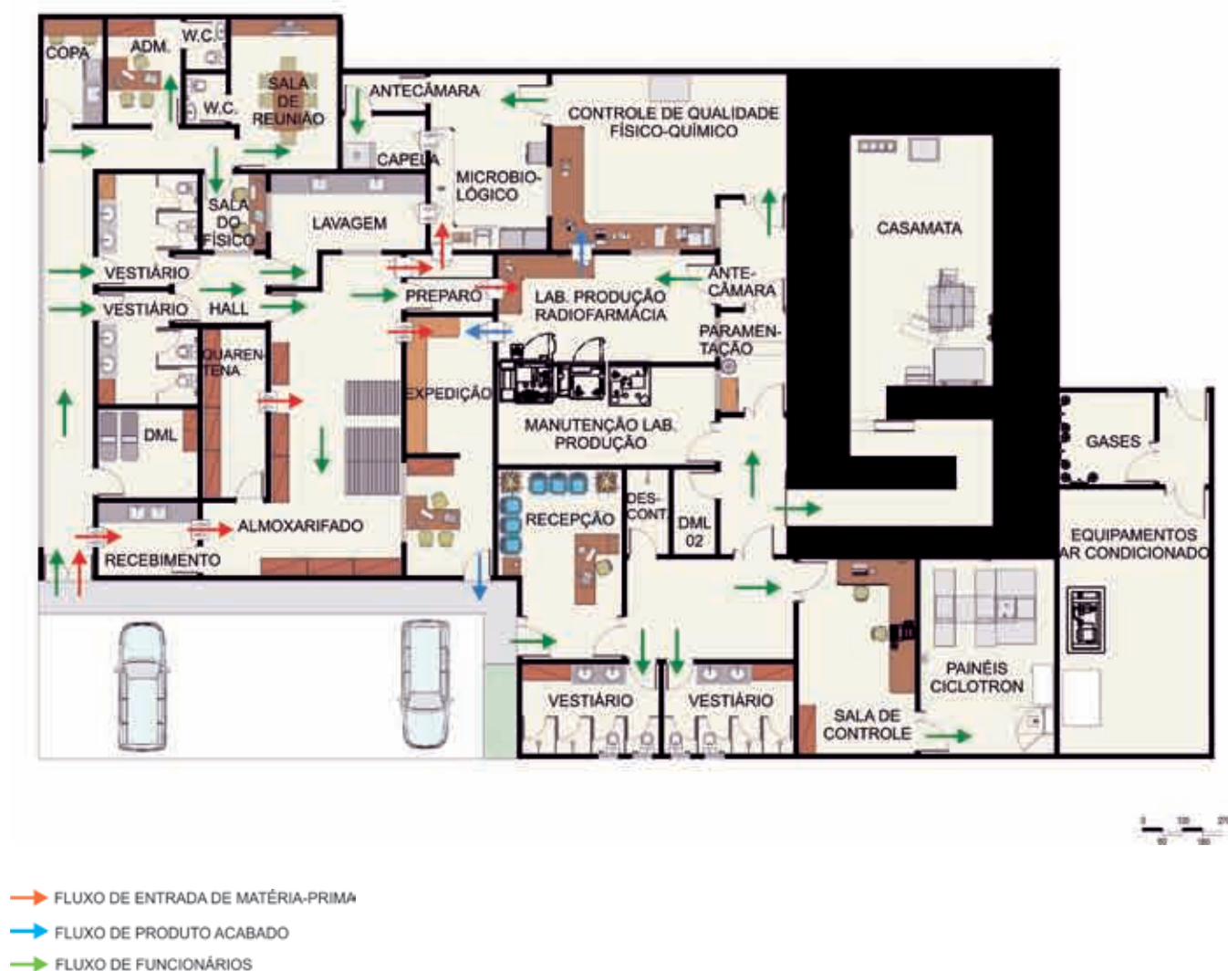
Fig.2 – Planta baixa de um Centro de Produção de Radiofármacos, com fluxos
